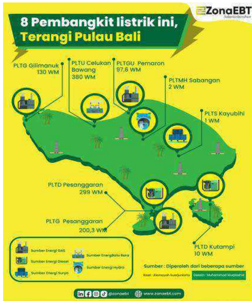
Gambar 2. 8 Pembangkit Listrik di Pulau Bali
